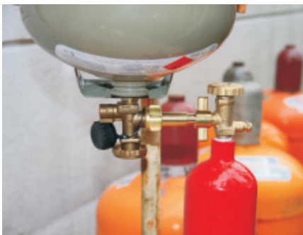
Die Spenderflasche muss zum Befüllen umgedreht werden und die Handwerkerflasche sicher mit der Spenderflasche verschraubt werden!
