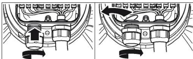
Abb. 4: Durchbruch Kabelverschraubung
