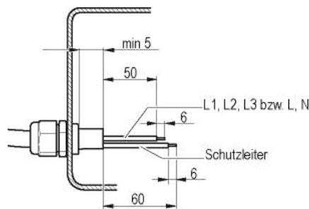
Abb. 1: Empfohlene Abmantelungslängen in mm (innerhalb Klemmkasten)
