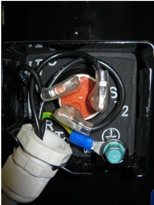
Abbildung 14: Ausführungsbeispiel mit Kabelverschraubung für Verdichtermodelle mit Schutzklasse IP21 (Modelle ZB15K* bis ZB45K*)
